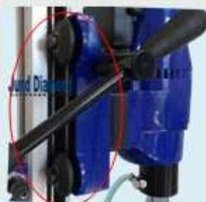
Equipada com Roldanas que deslizam na coluna, o que gera menos manutenção e facilita a retira do motor da Coluna
