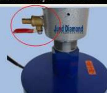
Equipada com Entrada de Água Para Refrigeração da broca Diamantada
