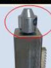
Além do sistema tradicional da fixação através da fenda da Base; É também equipada também com um dispositivo no topo da coluna que possibilita e facilita muito a fixação em operações sob tetos com fixação por pressão com hastes.
